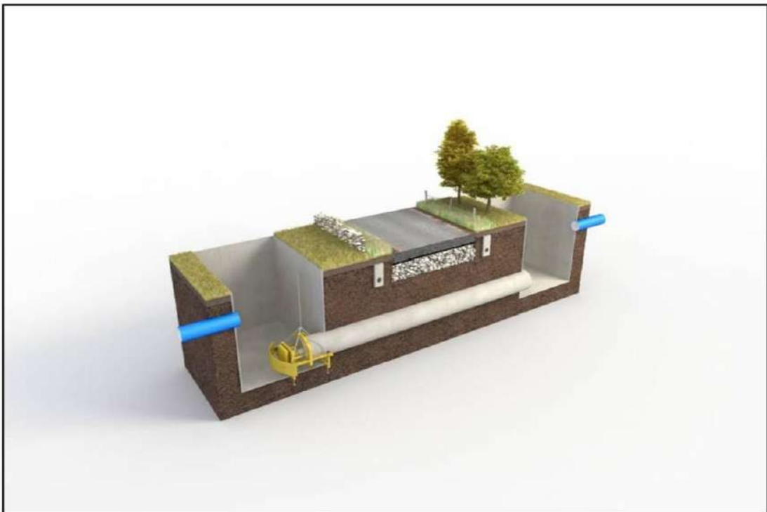
Figura 3.18: Esquema de microtunnelización
