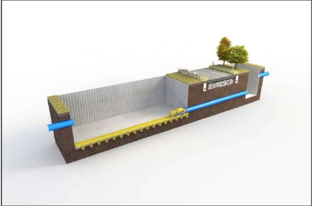
Figura 3.19: Esquema de perforación con auger
